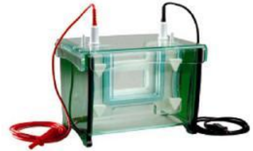
Cella elettroforetica nella tecnica del western blot (strumentazione cdl)
